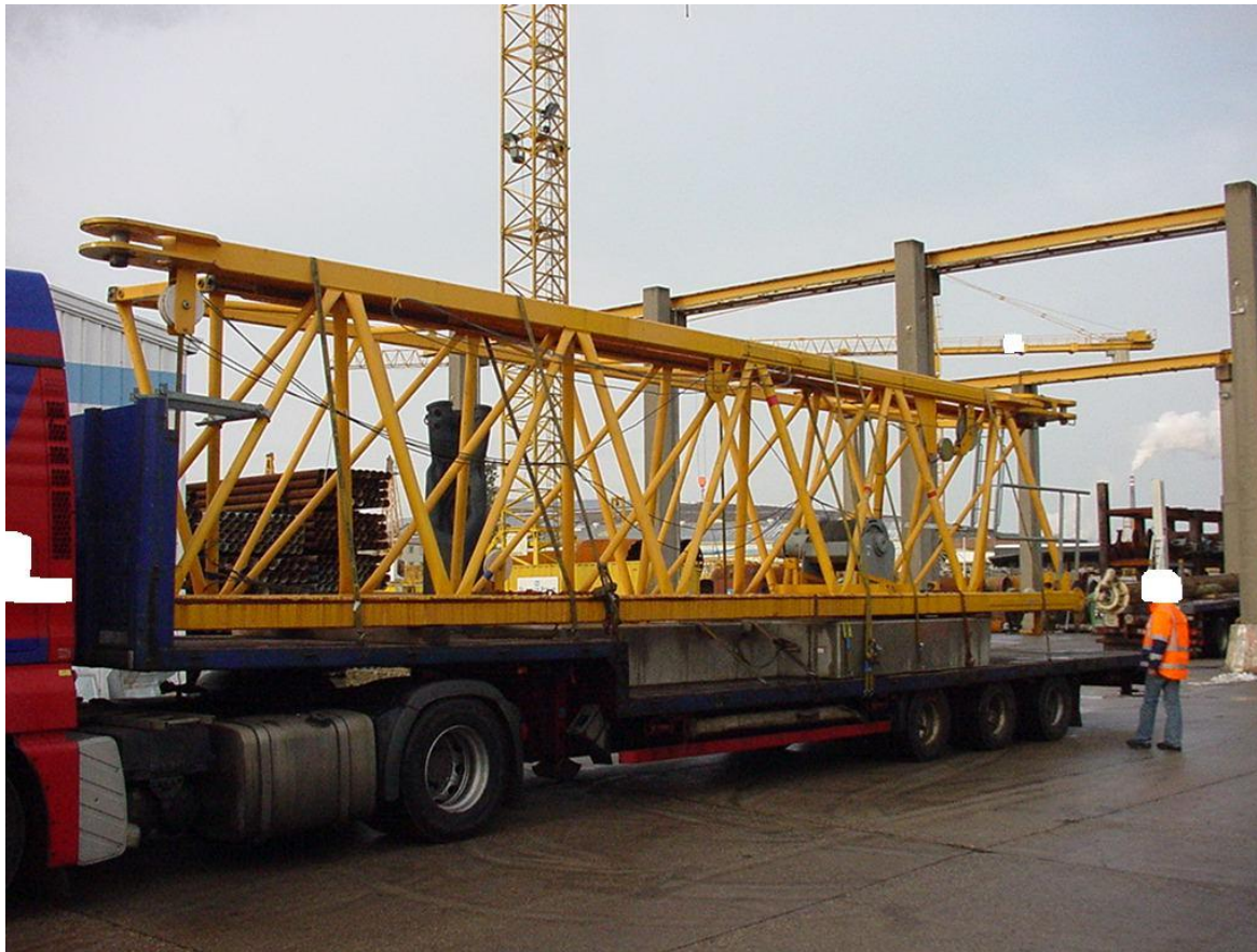
Transport von zwei Kontergewichten und einem Gittermastteil auf einem Standartsattelanhänger
