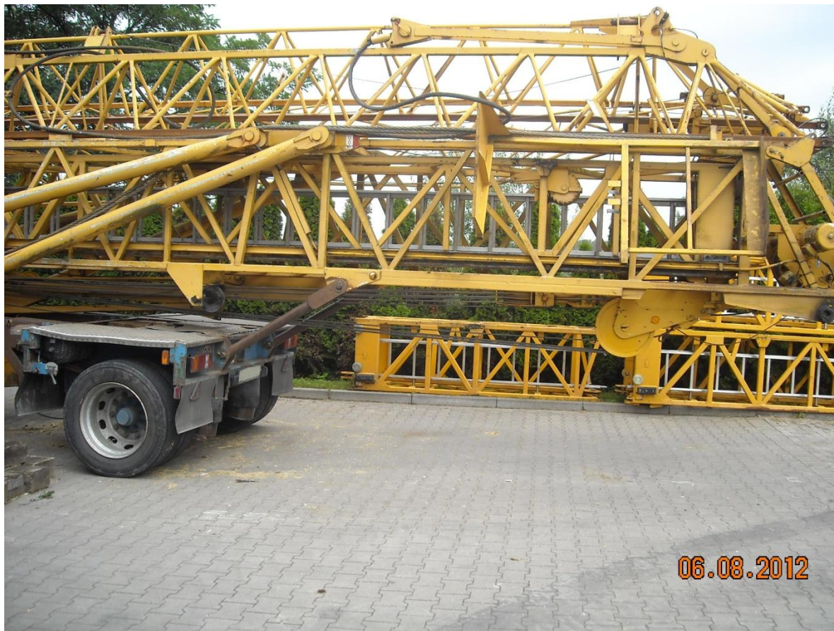
Montagestellung der hinteren Stützen.
