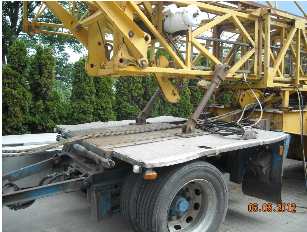
Montierte Abstützungen Vorderachse / Kran.
