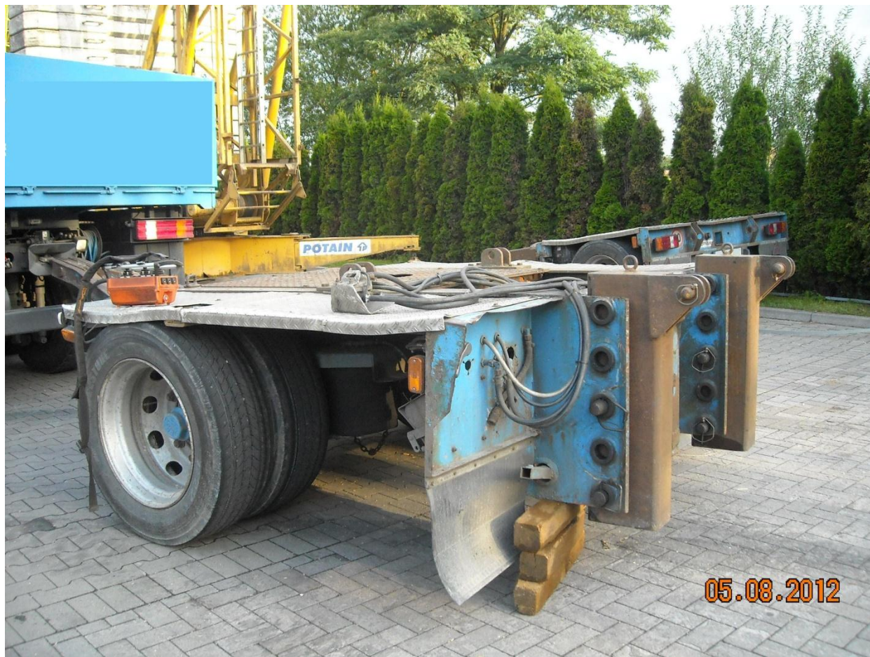
Vordere Achse des Anhängers mit eingeklappten Adaptoren für die Aufnahme des Turmdrehkranes
